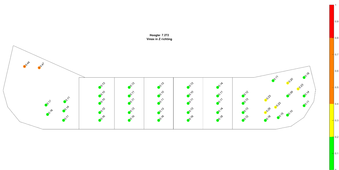
Figuur 3-3 Verdeling verticale trillingen (Z) op de 5 e verdieping (beton)
