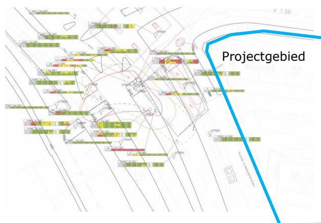
Figuur 3: Overzicht verontreinigingssituatie (aromaten) grondwater met in rood de interventiewaardecontour en in groen de streefwaardecontour
