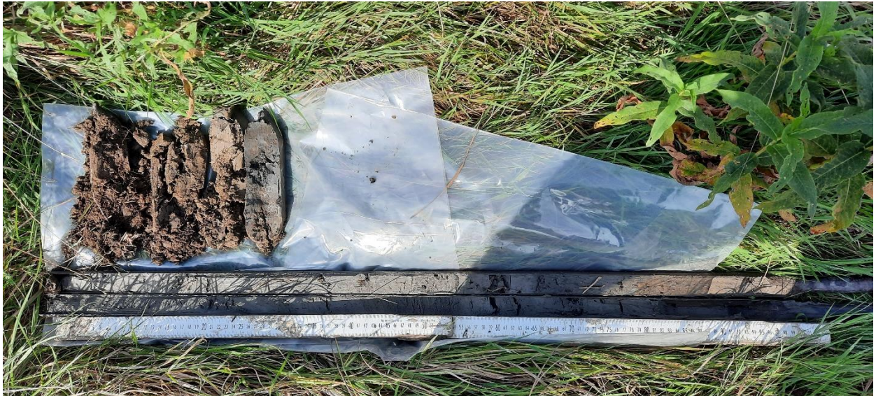
Foto van boring 1, tot 300 cm -Mv
