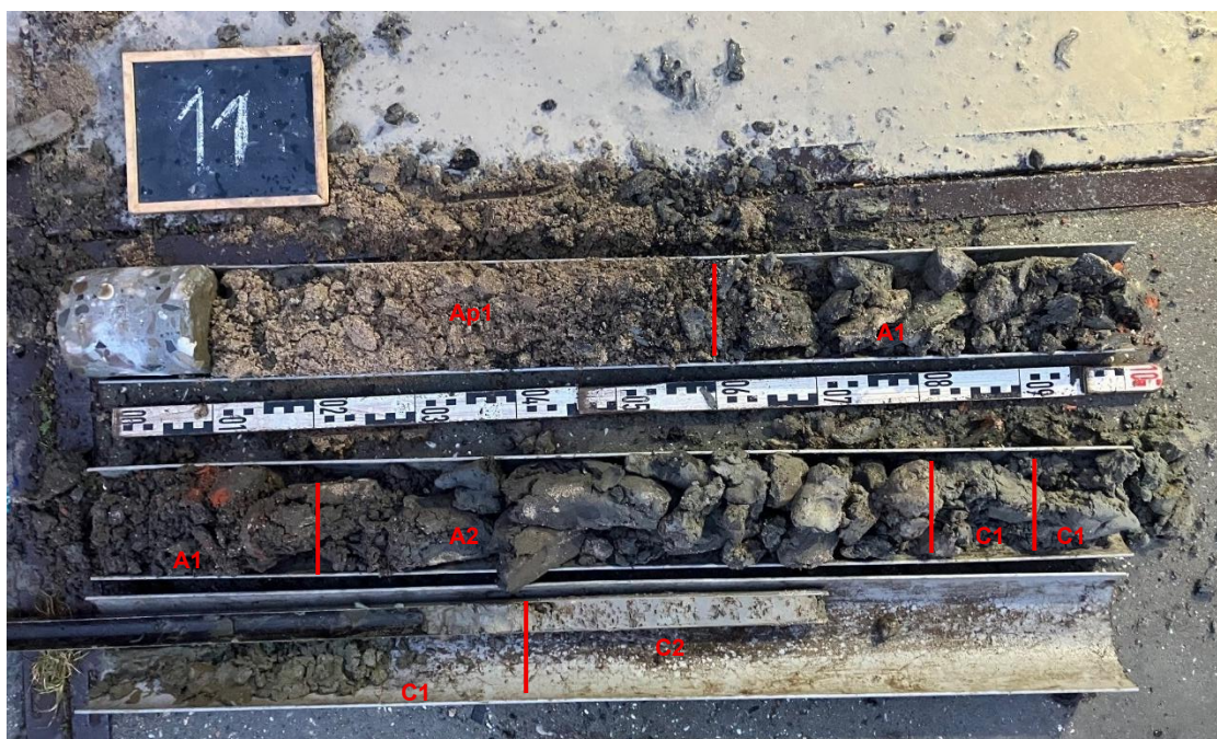
Afbeelding 31: Boring 11 met van linksboven naar rechtsonder het subrecente ophogingspakket (Ap1), de cultuurlagen in de oeverafzettingen (A1-A2), de 'schone' oeverafzettingen (C1) en de komafzettingen (C3).
