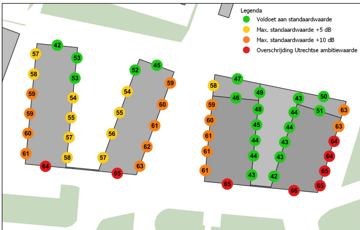
Fig. 4.2 – Rekenresultaten gemeentewegen. T,p,v, gele toetspunten wordt de standaardwaarde overschreden.
