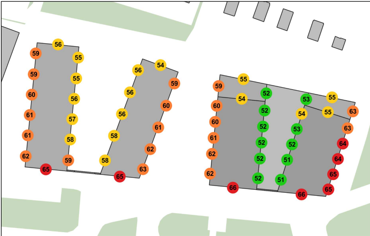
Fig. 4.5 – Gezamenlijk geluid L_g . De kleuren zijn hier enkel om in een oogopslag het grove verloop te zien.
