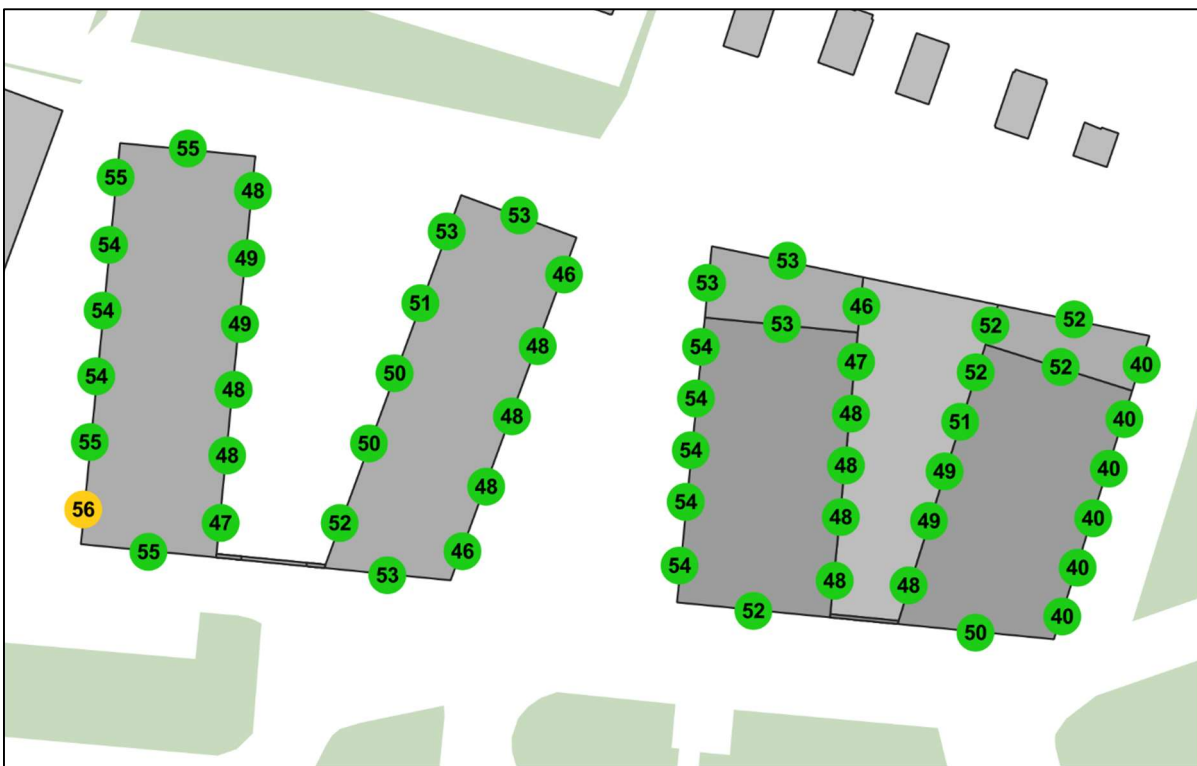
Fig. 4.3 – Rekenresultaten hoofdspoorwegen. T_{p,v} , het gele toetspunt wordt de standaardwaarde overschreden.
