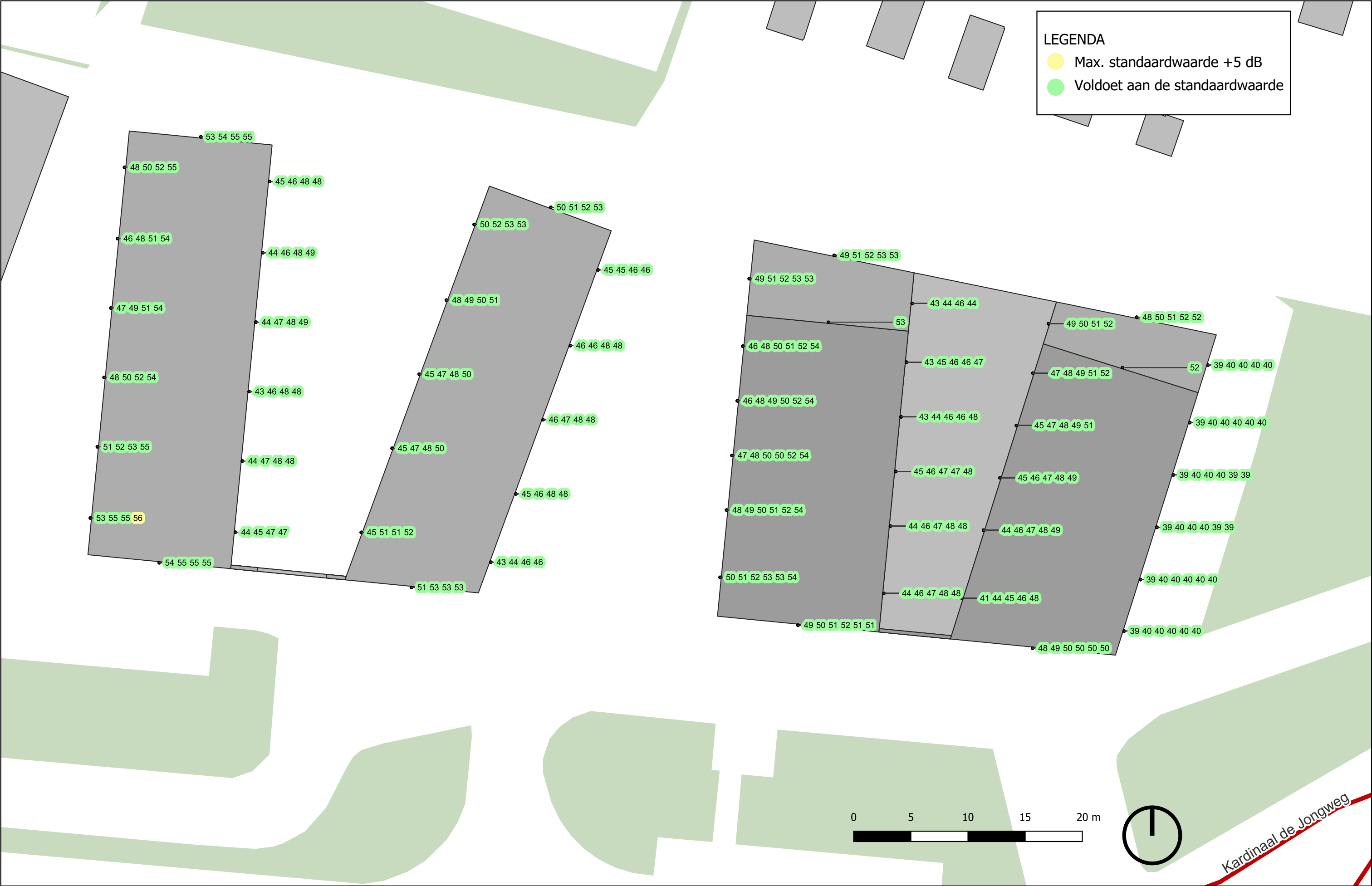
Geluidbelasting t.g.v. hoofdspoorwegen
