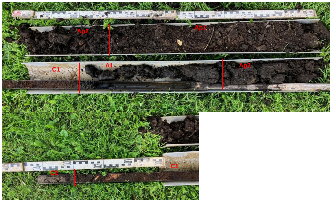
Afbeelding 22: Bodemopbouw in boring 1 (plangebied Kögllaan 26) met van rechtsboven naar linksonder het (sub)recent geroerde pakket (Ap1-Ap2), het veraarde veen (A1), het bosveen (C1) en het dekzand (C2).
