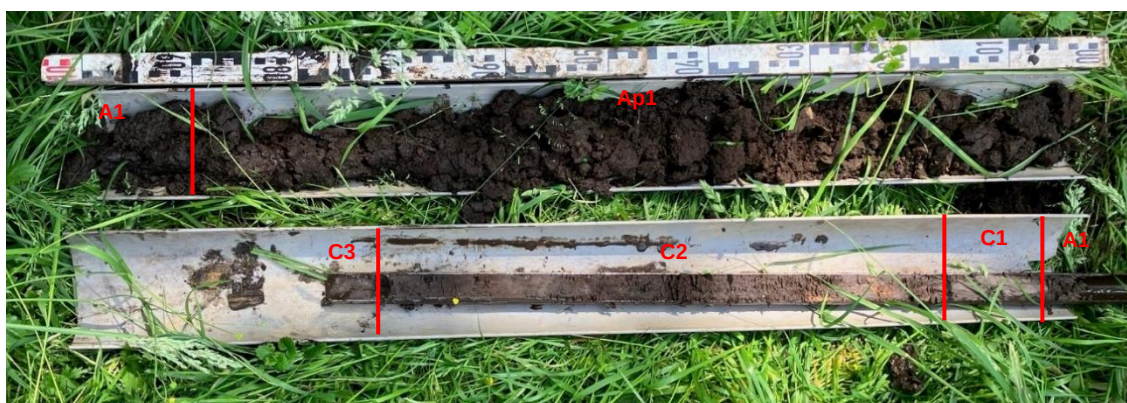
Afbeelding 21: Bodemopbouw in boring 5 (plangebied Kögllaan 26) met van rechtsboven naar linksonder het (sub)recent geroerde pakket (Ap1), het veraarde veen (A1), het komklei (C1), het zwak kleig bosveen (C2) en het dekzand (C3).
