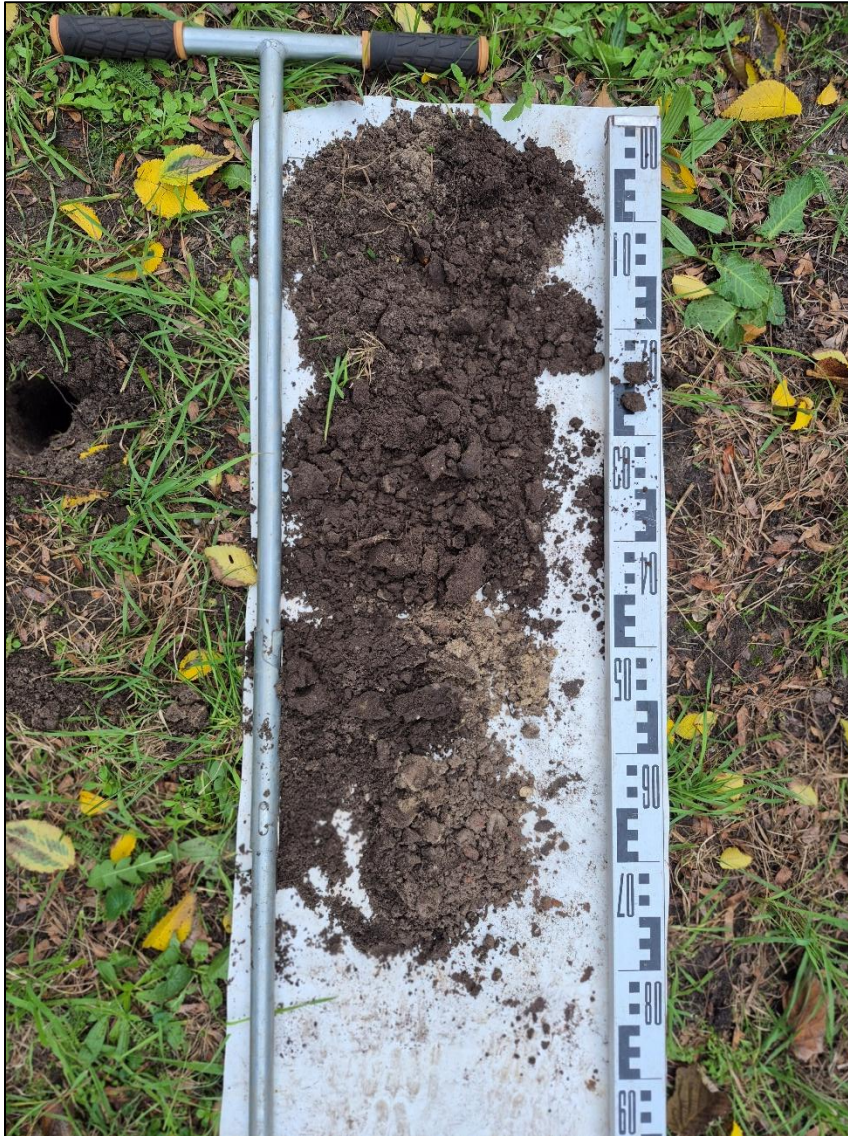
Afbeelding 11: Verdichte puinlaag op 60 cm diepte.
