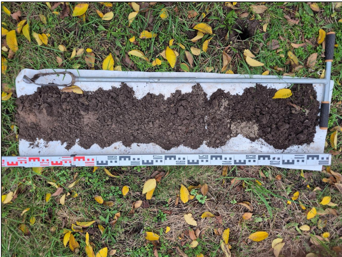
Afbeelding 10: Zandprofiel met afnemend gehalte organische stof.
