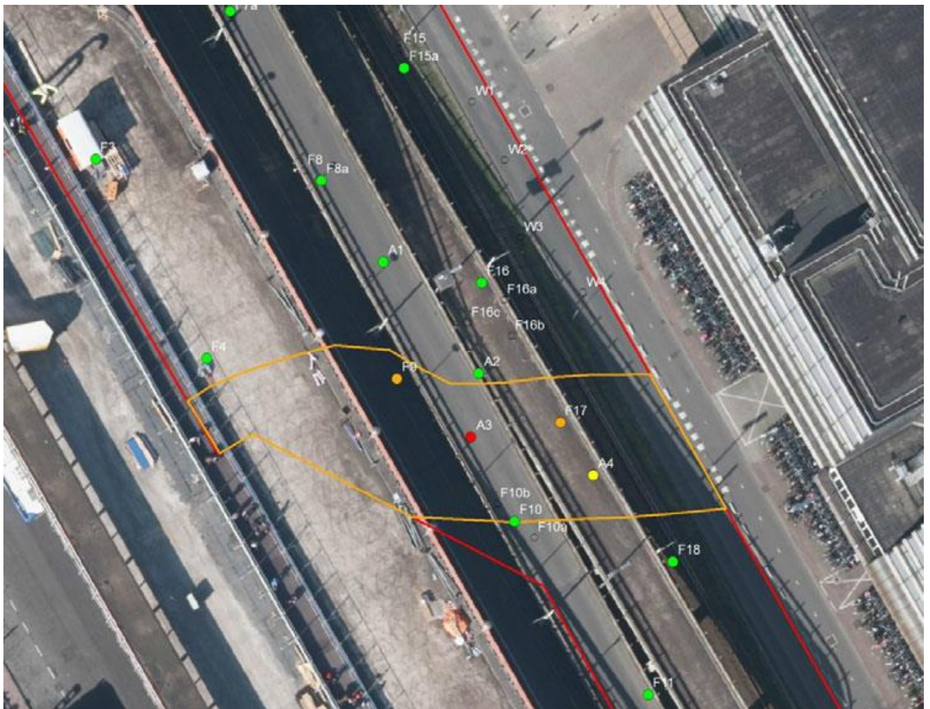
Figuur 3: Immobiele (sterke) koperverontreiniging binnen de contour van de fietsenstalling
