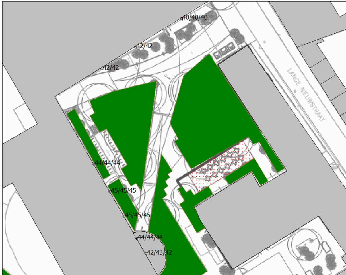
Figuur 3: Rekenresultaten stemgeluid (etmaalwaarde) op de verschillende verdiepingshoogtes
