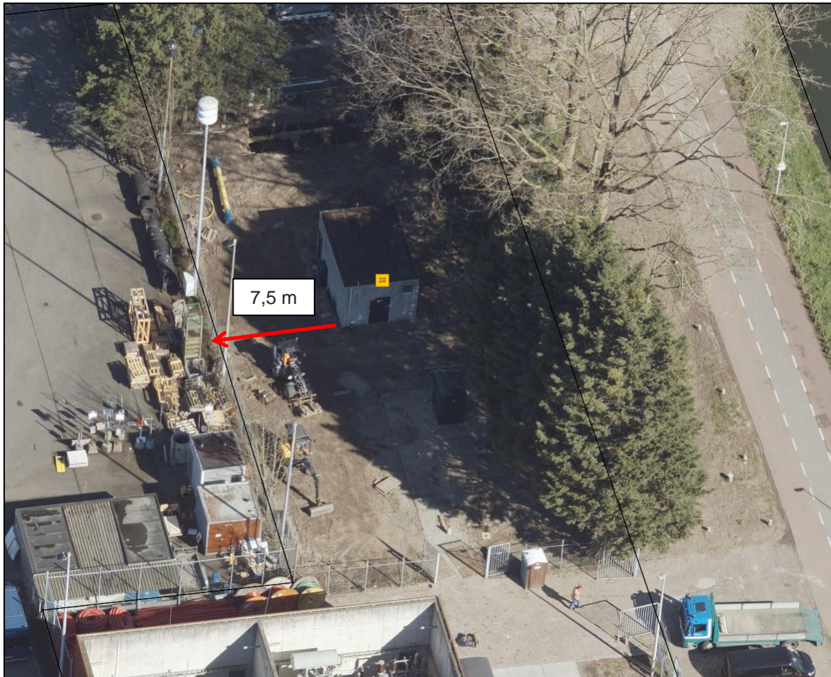
Figuur 4 Afstand gasverdeelstation tot inrichtingsgrens
