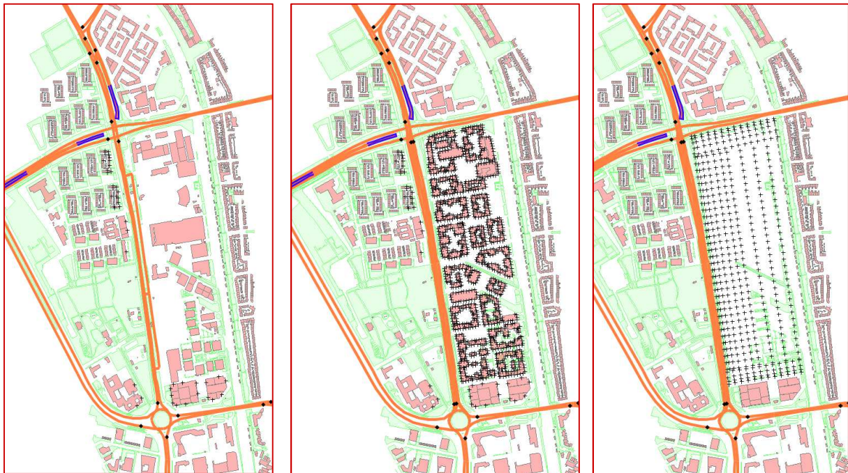
Figuur 6a: Rekenmodel wegverkeerslawaaï – bestaande situatie (wijziging van de weg), links Figuur 6b: Rekenmodel wegverkeerslawaaï – nieuwe situatie (wijziging van de weg en onderzoek op pandniveau),midden Figuur 6c: Rekenmodel wegverkeerslawaaï – nieuwe situatie (geluidscontouren plangebied), rechts
