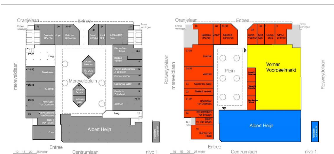
Figuur 2.1 De linker afbeelding geeft de huidige situatie weer. Op het binnenplein staan twee gebouwen en een aantal bomen. De rechter afbeelding geeft de beoogde situatie weer. De twee gebouwen op het binnenplein worden gesloopt. Aan de oostkant van het binnenplein worden de luifels gesloopt en vervolgens vindt er uitbreiding van de winkels plaats. De uitbreiding betreft één bouwlaag
