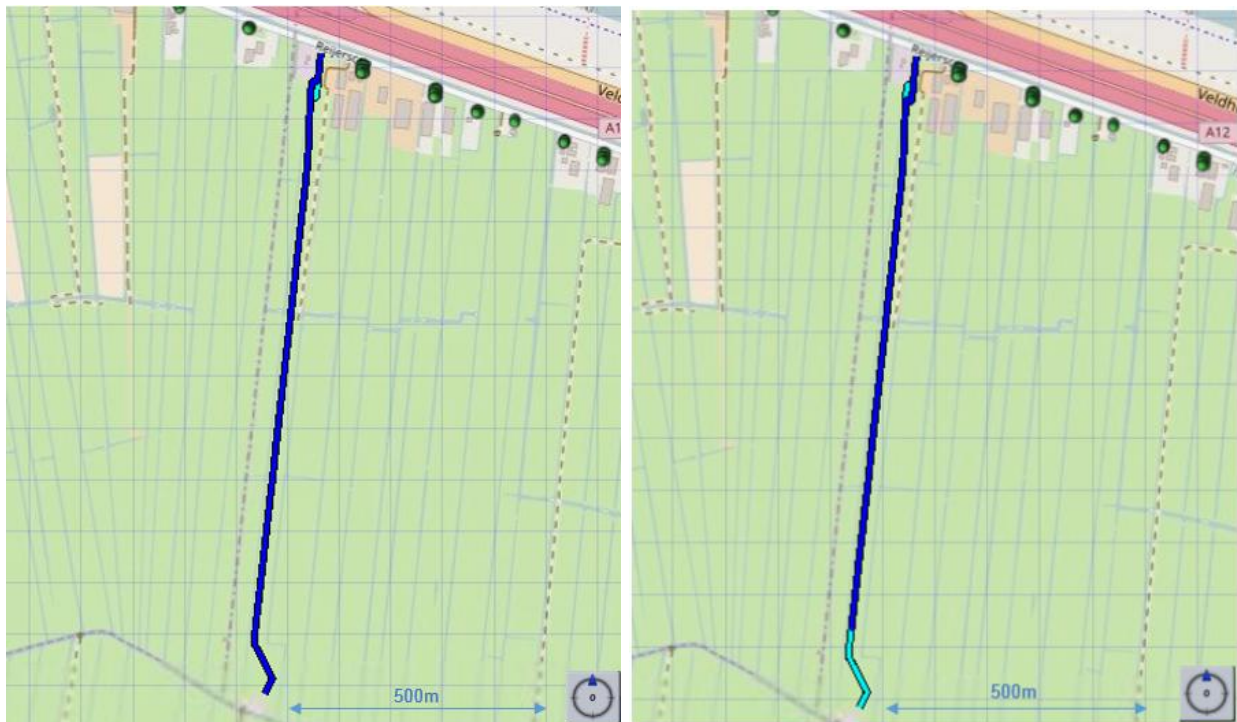
Figuur 1 Ligging van gastransportleiding W-518-06. De ligging van de leiding in de huidige situatie is in de linker afbeelding weergegeven in het donkerblauw, en de leiding na de verlegging is in de rechter afbeelding in het donkerblauw weergegeven.
