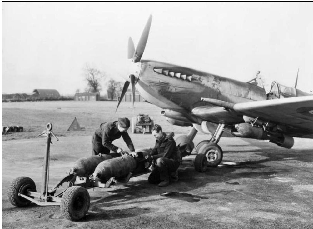
Figuur 22. Een Spitfire jachtbommenwerper beladen met 250 lb. brisantbommen onder de vleugels. Op de trolley voor het vliegtuig bevinden zich brisantbommen MC van 500 lb.
