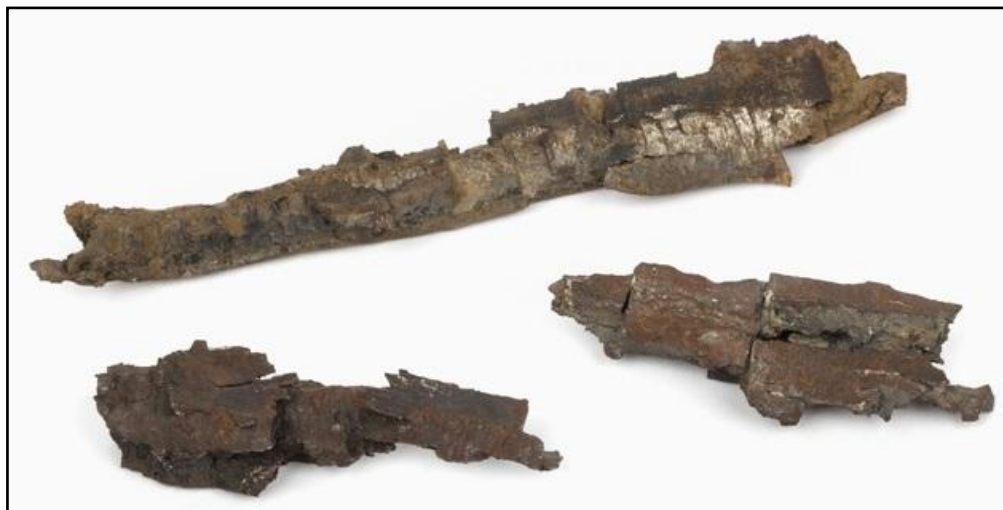
Figuur 24. Scherven afkomstig van een projectiel gevuld met springstof, na detonatie.
