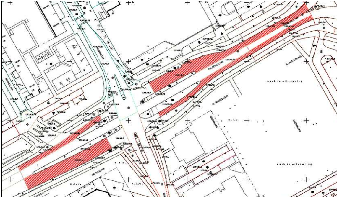
Figuur 11 : Aanwezig stil wegdek op de Churchilllaan (Dunne Deklaag B), overig referentie wegdek (DAB)
