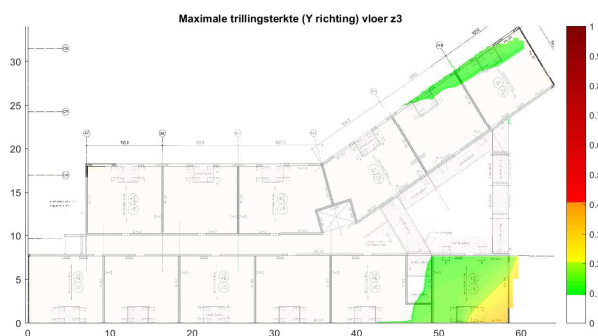
f4.3 Maximale trillingsterkte contour, vloerniveau 3, Y-richting ontwerp
