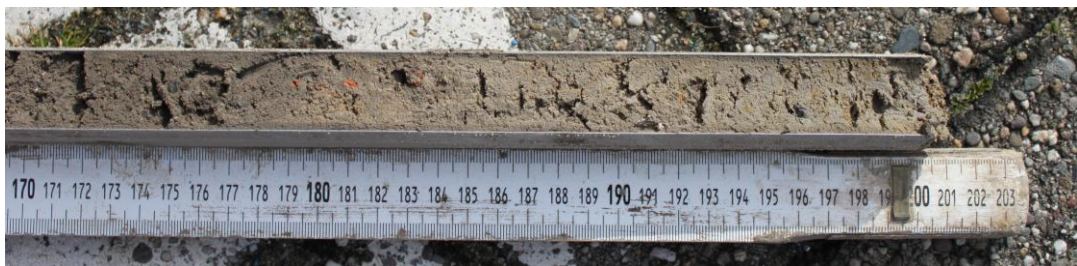
Figuur 8: Boring 9, traject met uiterst fijn, zwak tot uiterst siltig zand. In dit traject bevinden zich fosfaatconcreties, roestvlekken en houtskoolspikkels. In het bovenliggende pakket zijn brokjes baksteen c.q. roodbakend aardewerk zichtbaar.
