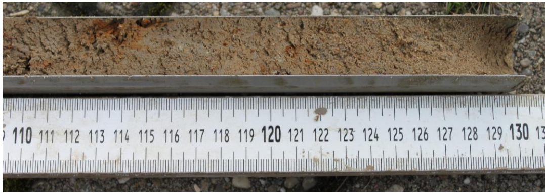
Figuur 5: Boring 5, zavelig pakket op 110 - 130 cm -Mv.
