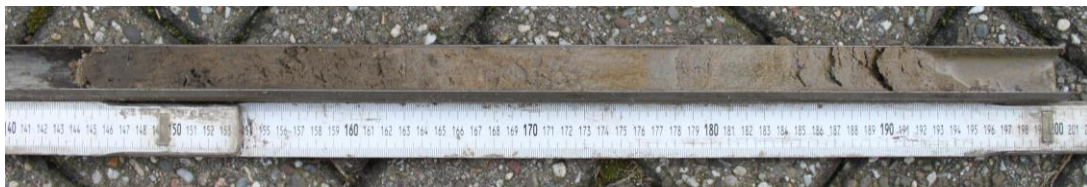
Figuur 12: Boring 11, Overgang humeuze zwak zandige klei naar onderliggende zeer fijn zand met kleilagen (Meetlat = diepte -Mv). Fijnzandige en kleihoudende oeverafzettingen.
