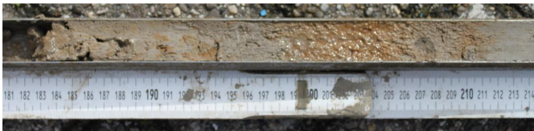
Figuur 9: Boring 9, vervolg van het traject als in figuur 8 (meetlat = diepte -Mv).
