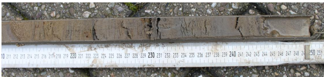
Figuur 13: Boring 11, vervolg traject figuur 12 (meetlat = diepte -Mv). Fijnzandige kronkelwaard – oeverwalafzettingen.
