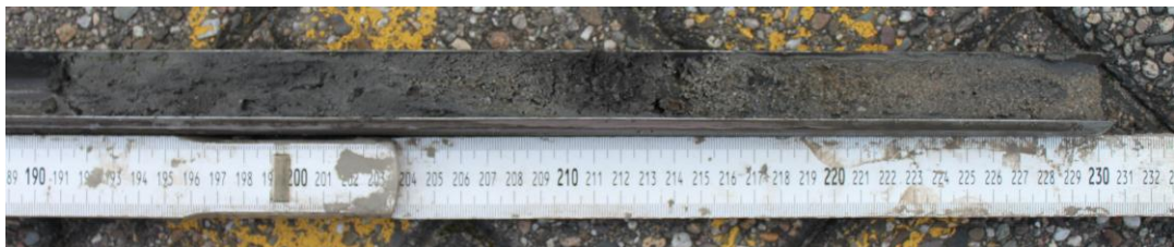
Figuur 7: Boring 7, overgang van zeer grofzandige beddingafzettingen in bovenliggende zwak zandige en matig humeuze klei. In deze klei is een brokje baksteen aangetroffen.
