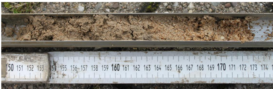
Figuur 14: Boring 11, vervolg traject figuur 13 (meetlat = diepte -Mv). Grofzandige beddingafzettingen.
