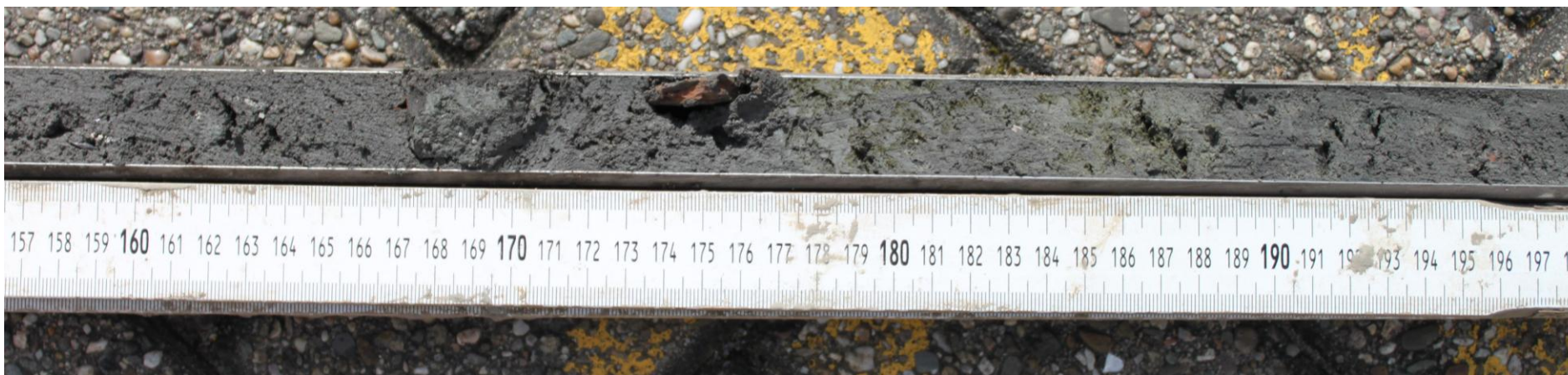
Figuur 15: Boring 7, traject homogene humeuze zwak zandige klei met fosfaatconcreties en schelpfragmenten. In de guts is ook een brokje/scherfje baksteen c.q. roodbakkend aardewerk zichtbaar.
