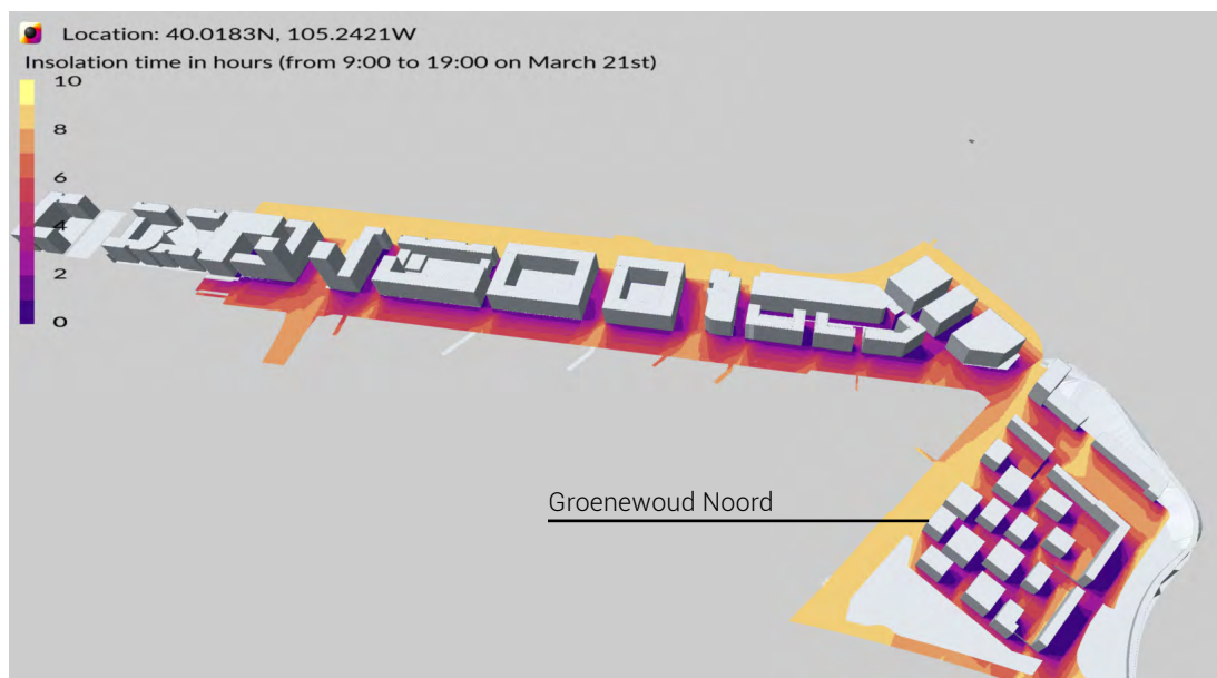
figuur 6 bezonning straten, ruimte tussen de gebouwen in Groenewoud Noord
