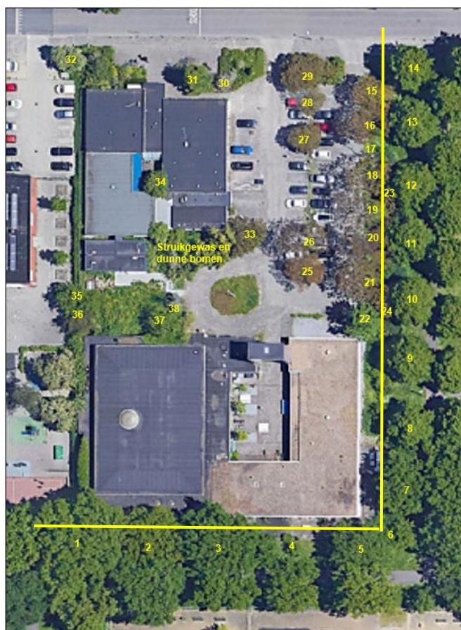
Bomenkaart met in geel de hekken om de boom-groeiplaatsen te beschermen op min. 5 m van de stammen. Aan de binnenzijde van de hekken kunnen rijplaten worden aangebracht om de groeiplaatsen te beschermen tijdens de werkzaamheden.
