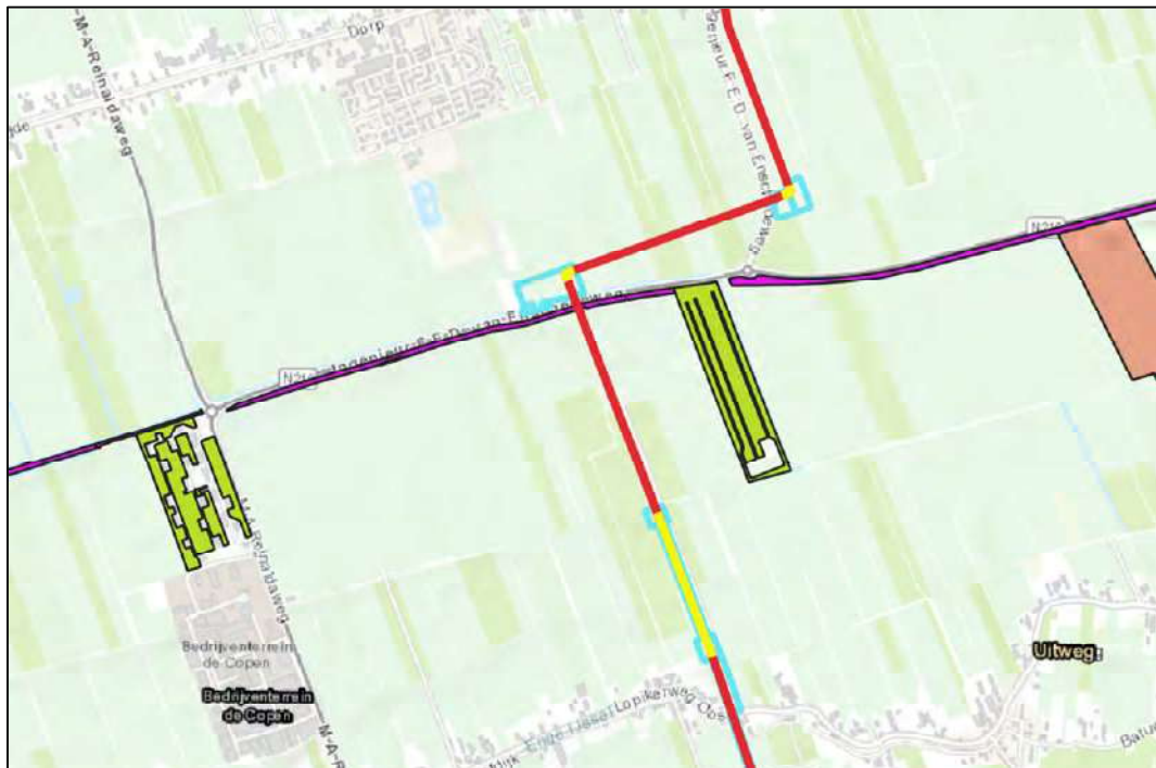
Figuur 4.36. Ligging van het HTL tracé (rood = HDD, geel = open ontgravingen) en de werkstroken (blauw) ten opzichte van het NNN-gebied parallel aan de N210. De verschillende kleuren geven de beheertypen weer van de NNN-gebieden (bron achtergrond: Esri).
