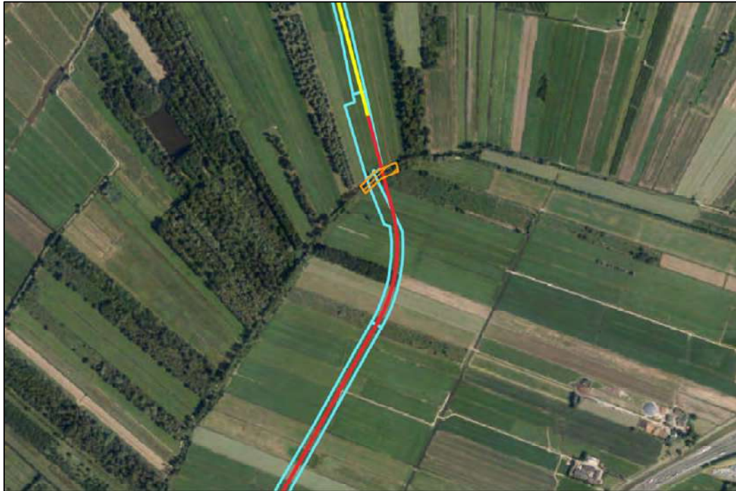
Figuur 5.3. Ligging van de tracés (rood = HDD, geel = open ontgravingen) en de werkstroken (blauw) ten opzichte van de mogelijke broedlocaties steenuil (oranje) (bron achtergrond: Esri).
