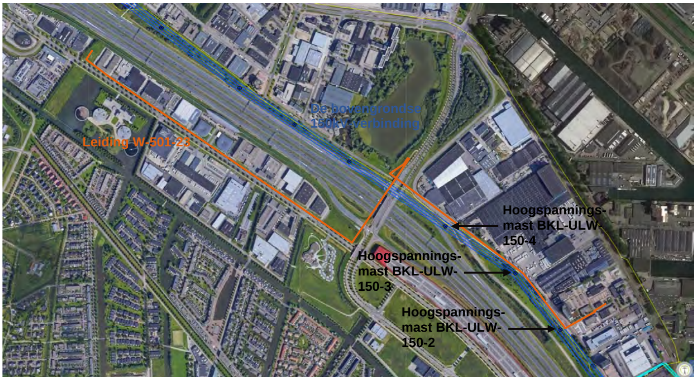
Figuur 3: De drie hoogspanningsmasten van de bovengrondse 150kV-verbinding in de nabijheid van leiding W-501-23.
