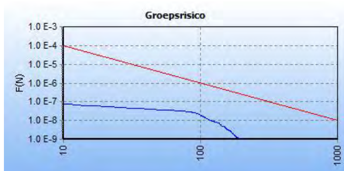
Figuur 10: De fN-curve voor deze kilometer leiding (leiding W-501-23).
