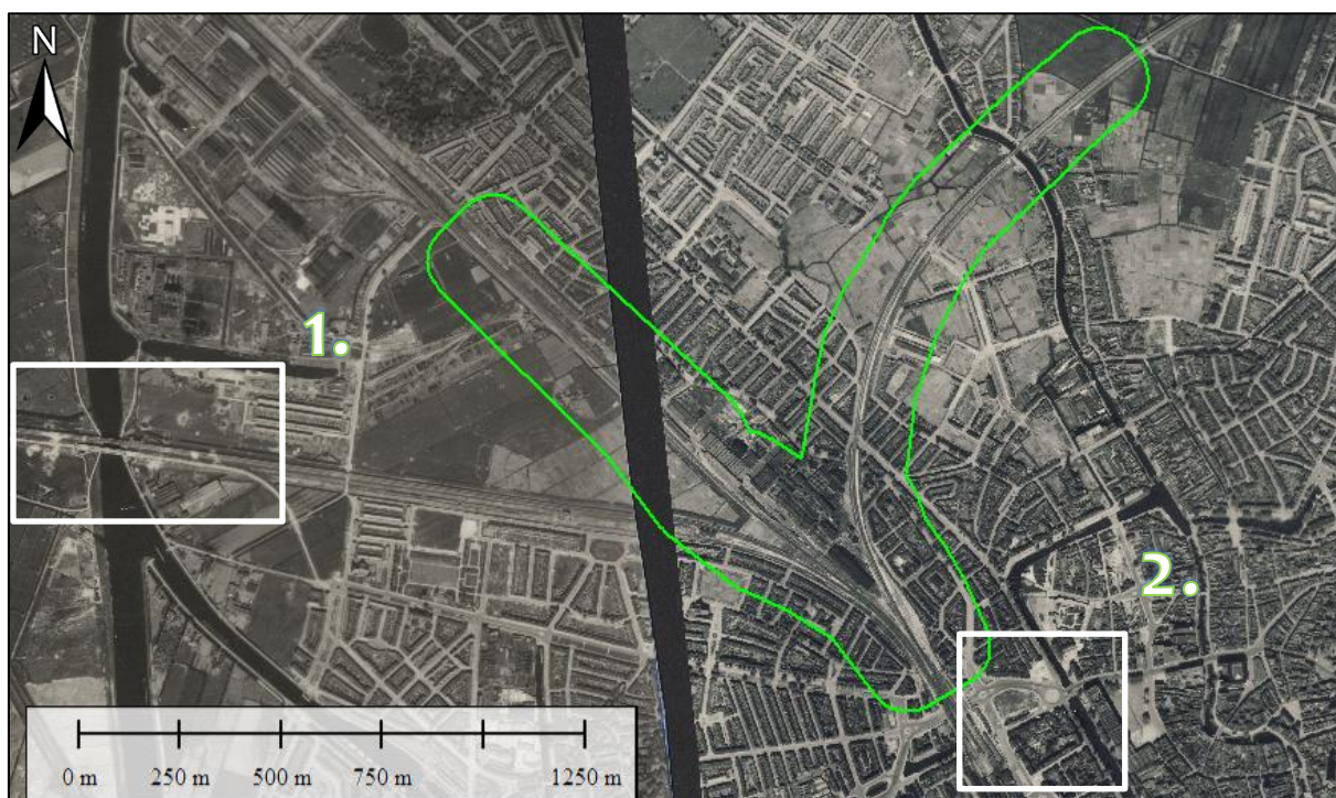
Figuur 35. Overzichtsfoto met locaties van kraters en beschadigingen ten zuidoosten en westen van het projectgebied op de luchtfoto's van 19 april 1945.
