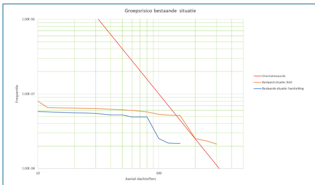
Figuur 5-1 Berekening van het groepsrisico voor de bestaande situatie met verschillende populatiedichtheden
