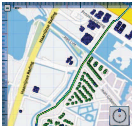
Figuur 33: Overschrijding van het groepsrisico als functie van de afstand (stationing) van de W-501-02.
