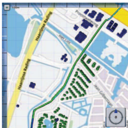
Figuur 31: Overschrijding van het groepsrisico als functie van de afstand (stationing) van de W-501-01.
