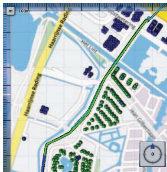
Figuur 43: Overschrijding van het groepsrisico als functie van de afstand (stationing) van de W-501-02.
