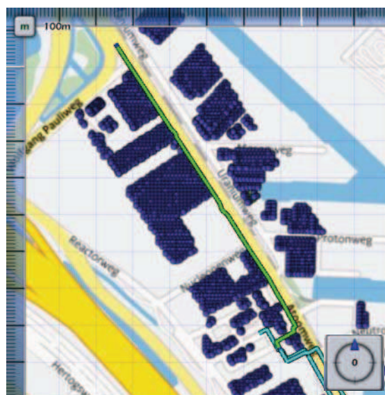
Figuur 51: Overschrijding van het groepsrisico als functie van de afstand (stationing) van de W-501-16.
