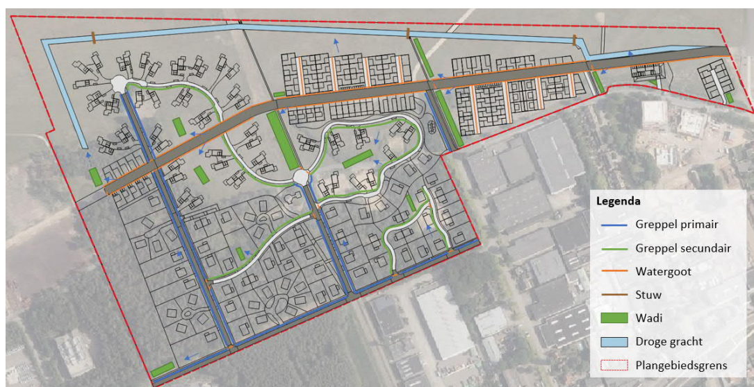
Figuur 4 Schematische weergave van de hemelwaterstructuur
