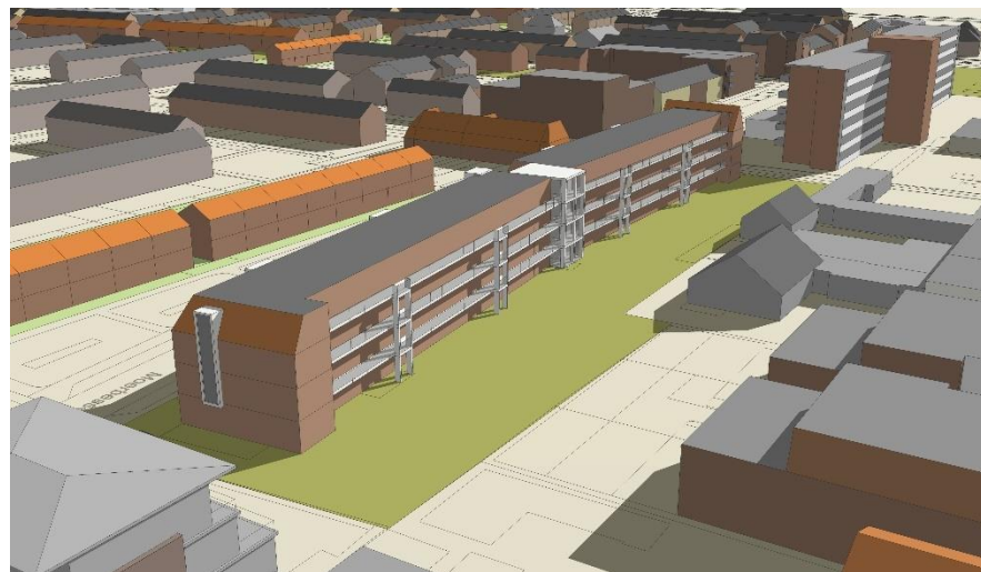
Afb. 44 Ontsluiting middels galerijen aan achterzijde
