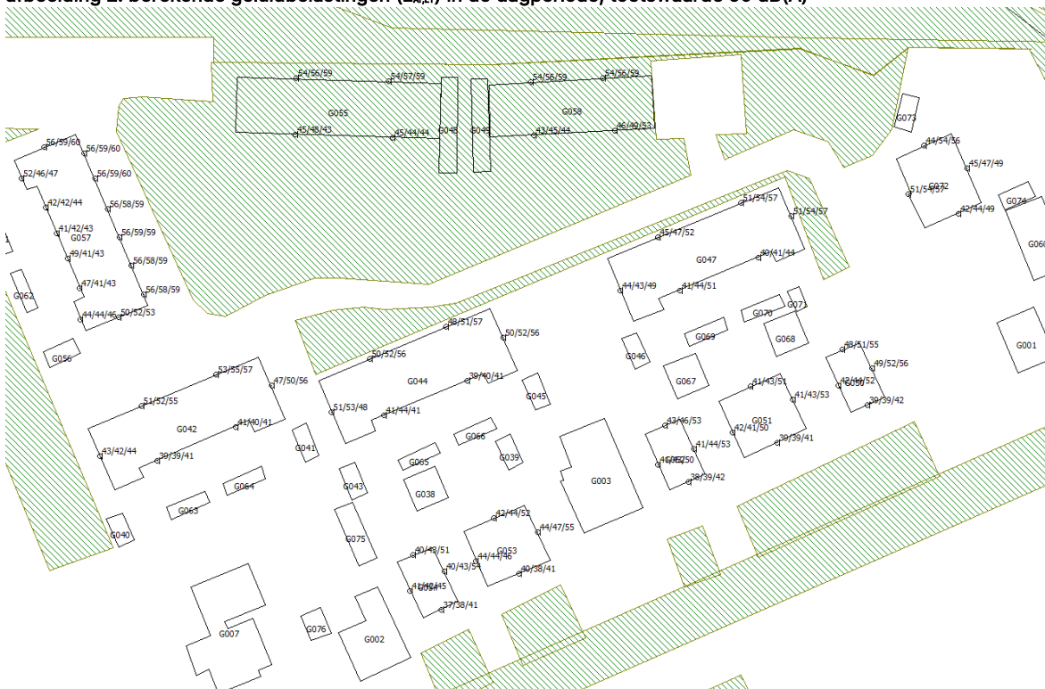
afbeelding 2: berekende geluidbelastingen ( L_{A,T} ) in de dagperiode, toetswaarde 50 dB(A)
