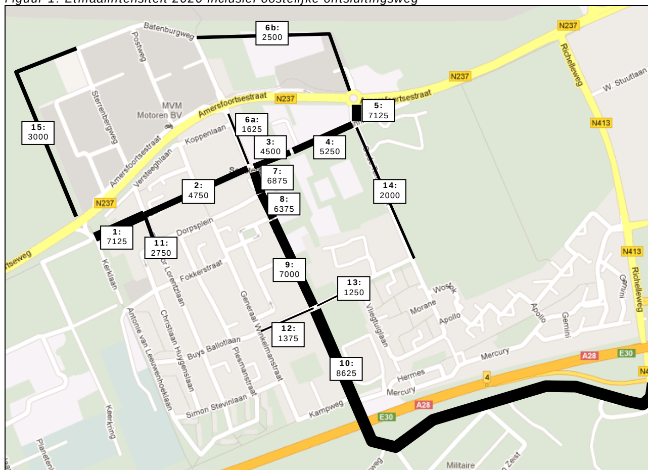
Figuur 1: Etmaalintensiteit 2020 inclusief oostelijke ontsluitingsweg
