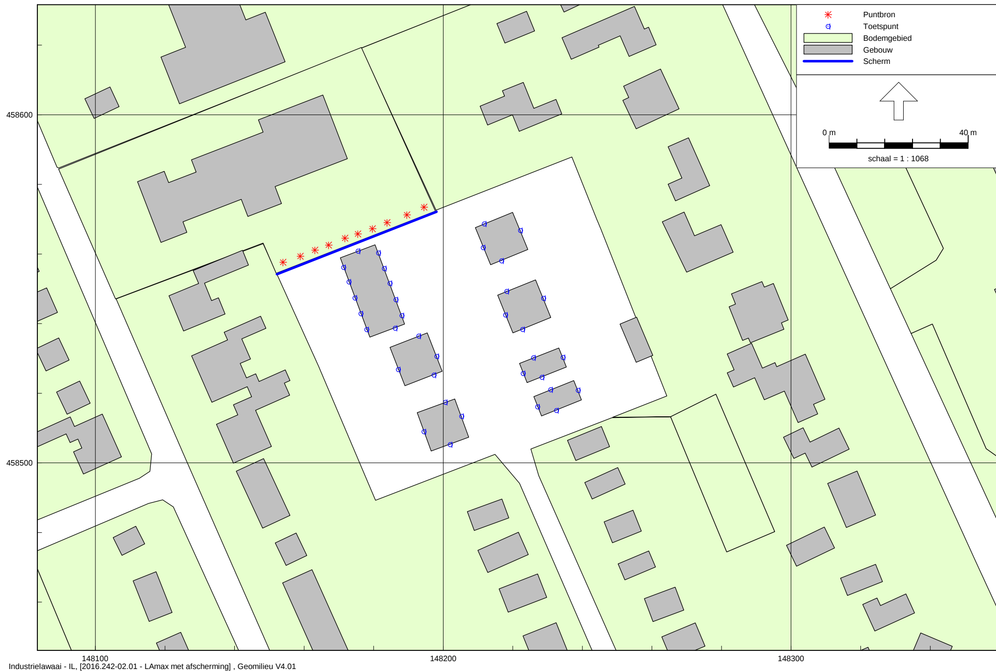
Figuur 5: Grafische weergave rekenmodel LAmix met afscherming
