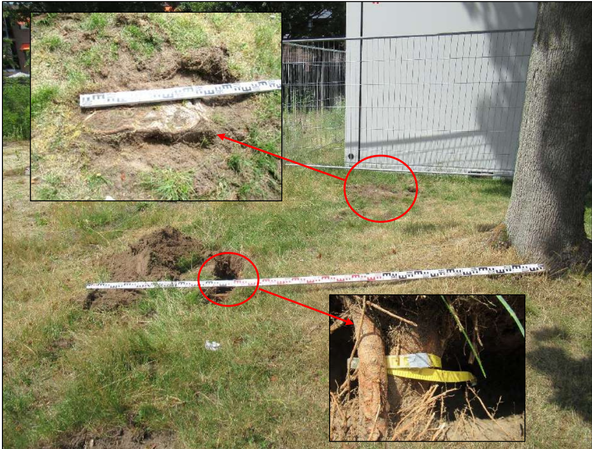
Foto 20: beeld maaiveld boom 2 Inzet: aangetroffen forse oppervlakkige beworteling in gazon
