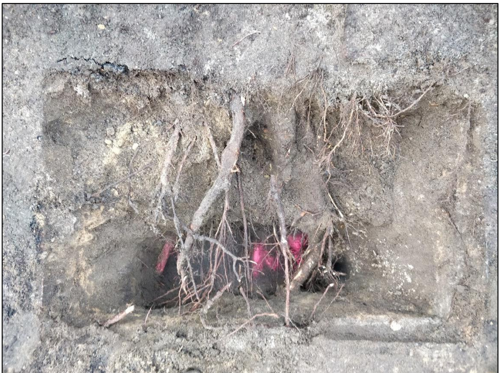
Afbeelding 8. Profielsleuf 1 detail; roze gemarkeerde beworteling op 0.60 m diepte
