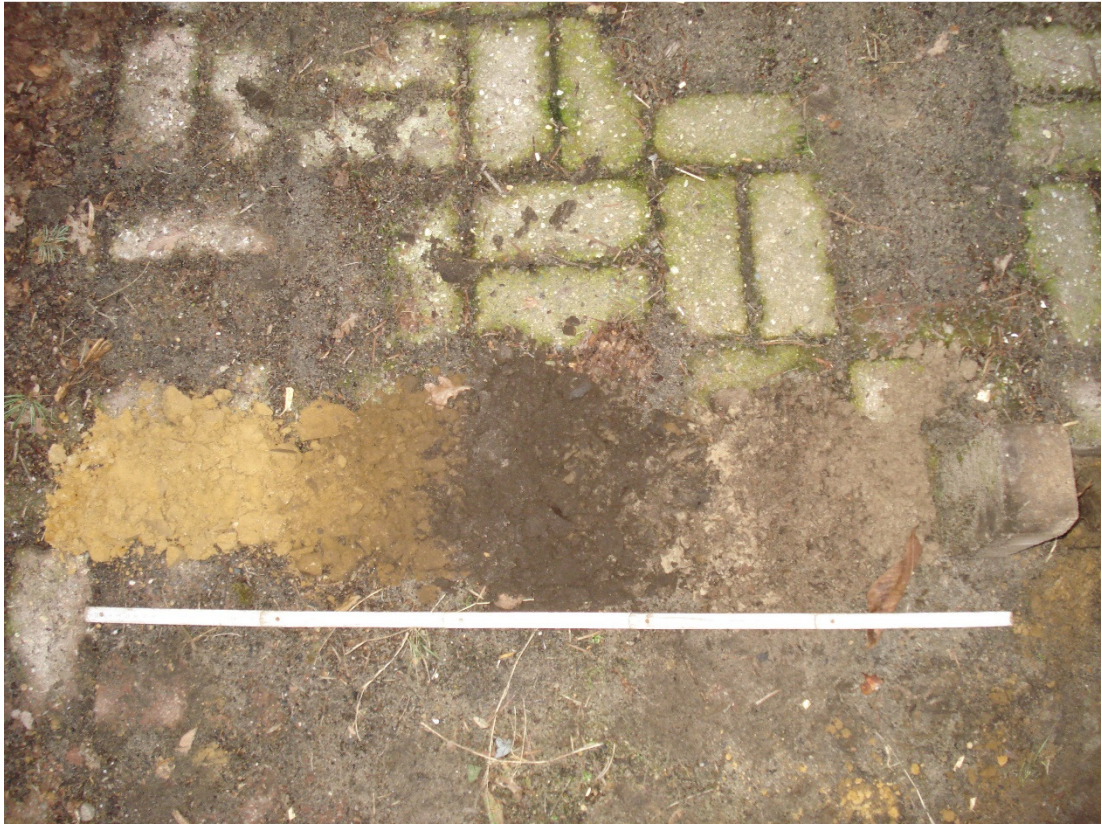
Afbeelding 12: Uitgelegde boorkolom van boring 5 met intacte bodem.
