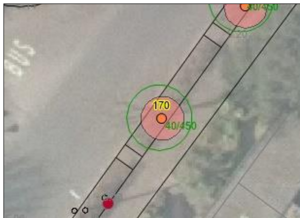
afb. 11: voorbeeld overschrijding graafafstand bij verwijderen huidige verharding
