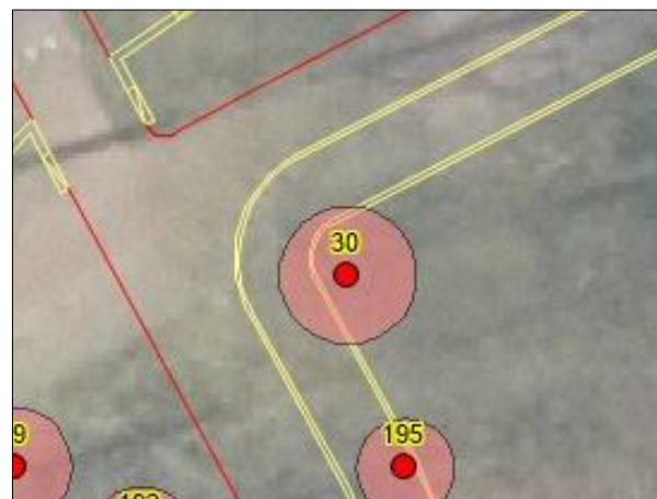
afb. 12: voorbeeld overschrijding graafafstand bij aanleg nieuwe verharding
