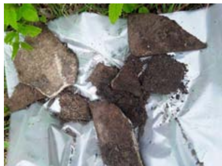
meetpunt 03, laag 0-50, bijz. asbestverdacht 6328267
