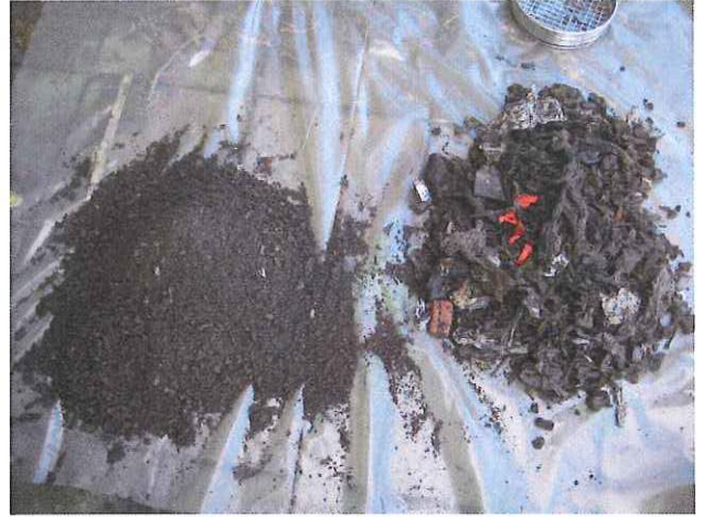
Fotonummer: 02 Omschrijving: Fracties na zeping op 16 mm
