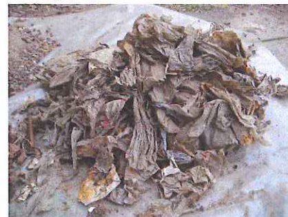
Fotonummer: 05 Omschrijving: Kunststoffractie > 16 mm
