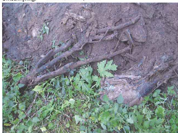
Fotonummer: 11 Omschrijving: Grove materialen; houtresten, boomwortels
