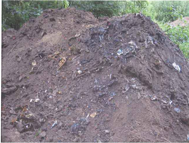
Fotonummer: 01 Omschrijving: Ontgraven stortmateriaal
