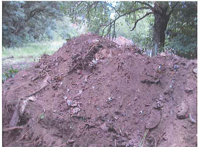
Fotonummer: 04 Omschrijving: Ontgraven stortmateriaal
