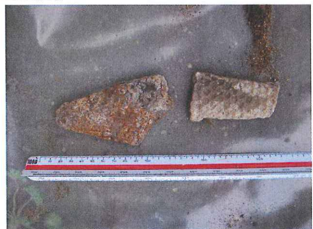
Fotonummer: 05 Omschrijving: Plaatjes asbestverdacht materiaal (> 16 mm)
