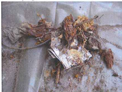
Fotonummer: 06 Omschrijving: Metaalfractie (> 16 mm)
