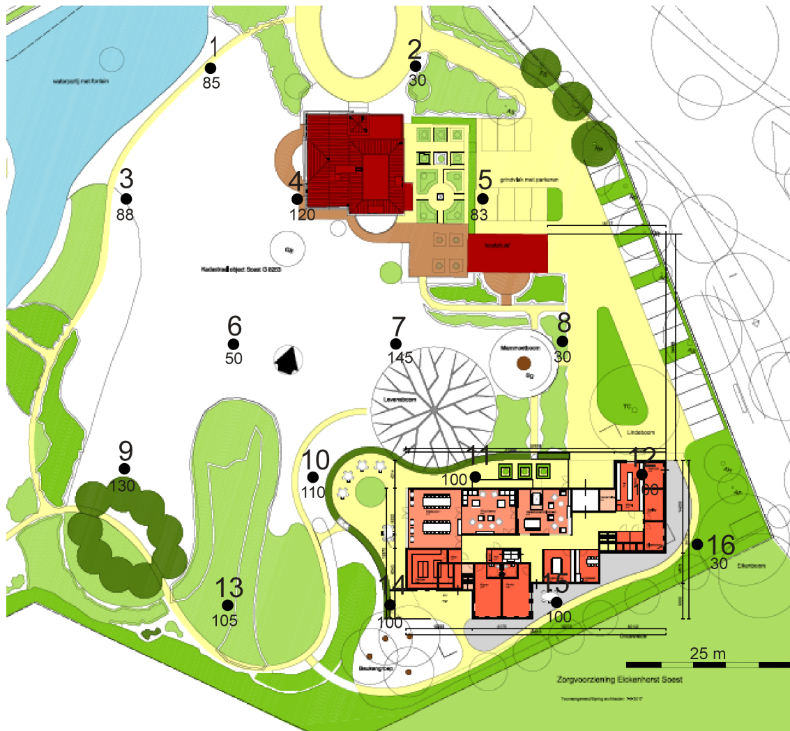
Figuur 8: Soest, Jachthuislaan 55: Boorpuntenkaart. Het deel van het plangebied waarop zal worden gebouwd ligt rechtsonder. De genummerde punten geven de boorpunten aan. Bij elk boorpunt is de dikte van de verstoorte bodem aangegeven in centimeters. In verband met de verdiepte ligging van de paardenbak is bij deze boorpunten (11, 12 en 15) tachtig centimeter opgeteld.
