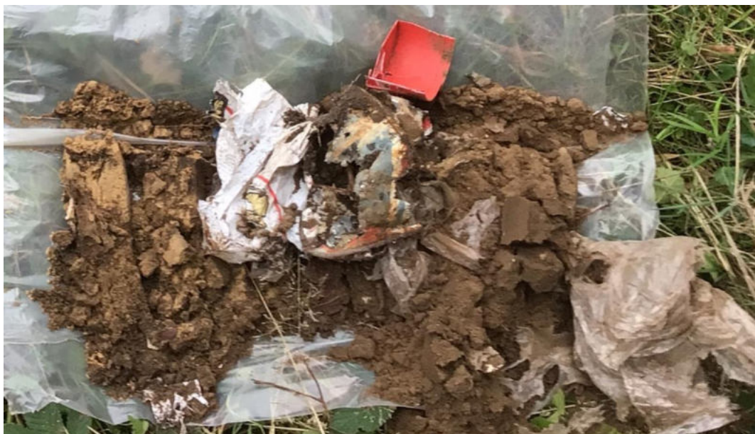
Figuur 4: De grote hoeveelheid plastic en blik aangetroffen tussen 0,5 en 1,0 m -mv bij boring 3.
