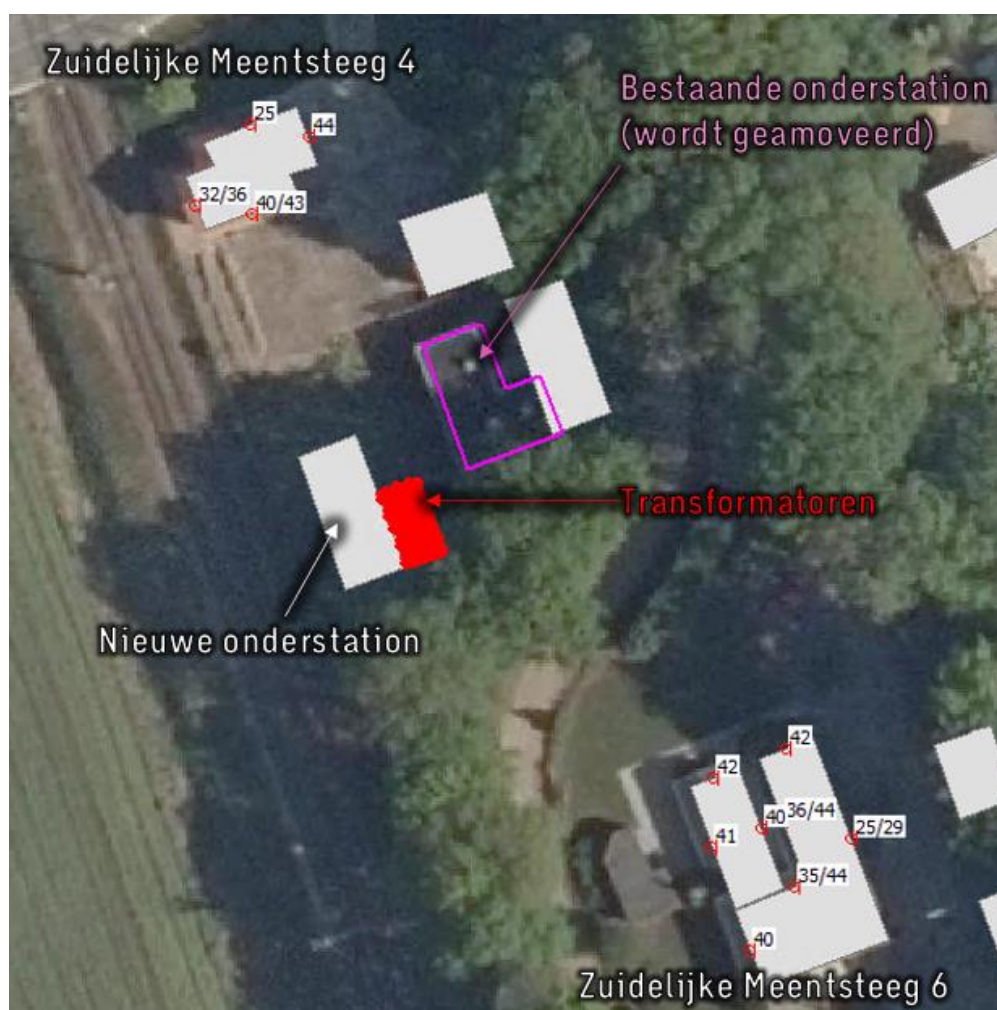
Figuur 4-1 Berekende etmaalwaarden op de twee dichtstbijzijnde woningen. Per gevel: eerste getal = 1,5m rekenhoogte (begane grond); tweede getal = 4,5m rekenhoogte (eerste verdieping).
