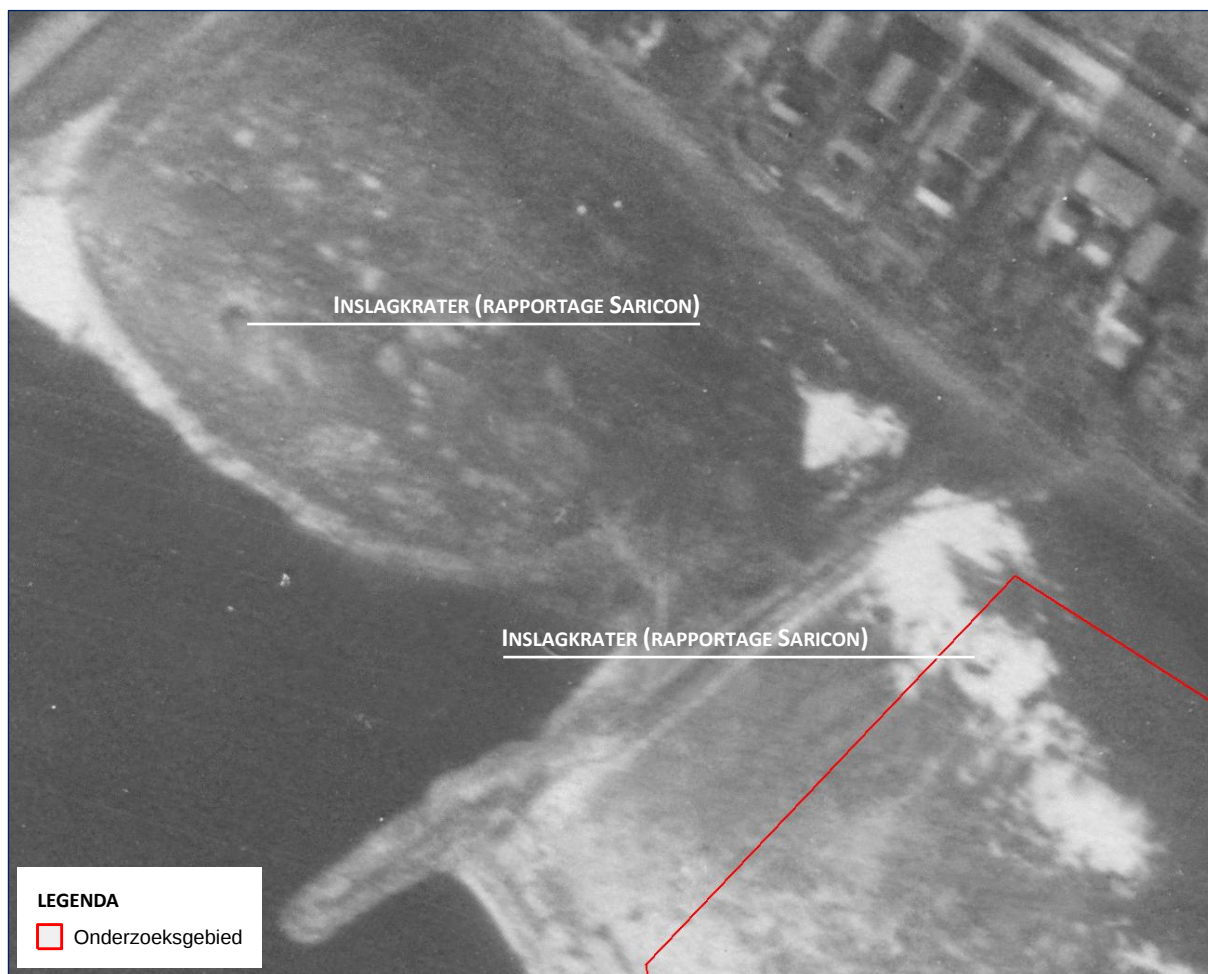
Figuur 21: Detail van een luchtopname van 5 januari 1945 van het uiterst westelijke gedeelte van het onderzoeksgebied. Volgens het rapport van Saricon zijn op de aangegeven locaties inslagkraters van afwerpmunitie zichtbaar. Op basis van een 3D-projectie van de luchtopnamen 3046 en 3047 (run nummer 4-1605) concludeert ECG dat de linkse “inslagkrater” geen verdieping, maar een verhoging in het landschap betreft en derhalve geen krater kan zijn. Met betrekking tot de rechter versterking biedt 3D-analyse geen uitsluitel of het hier een mogelijke inslagkrater betreft.
