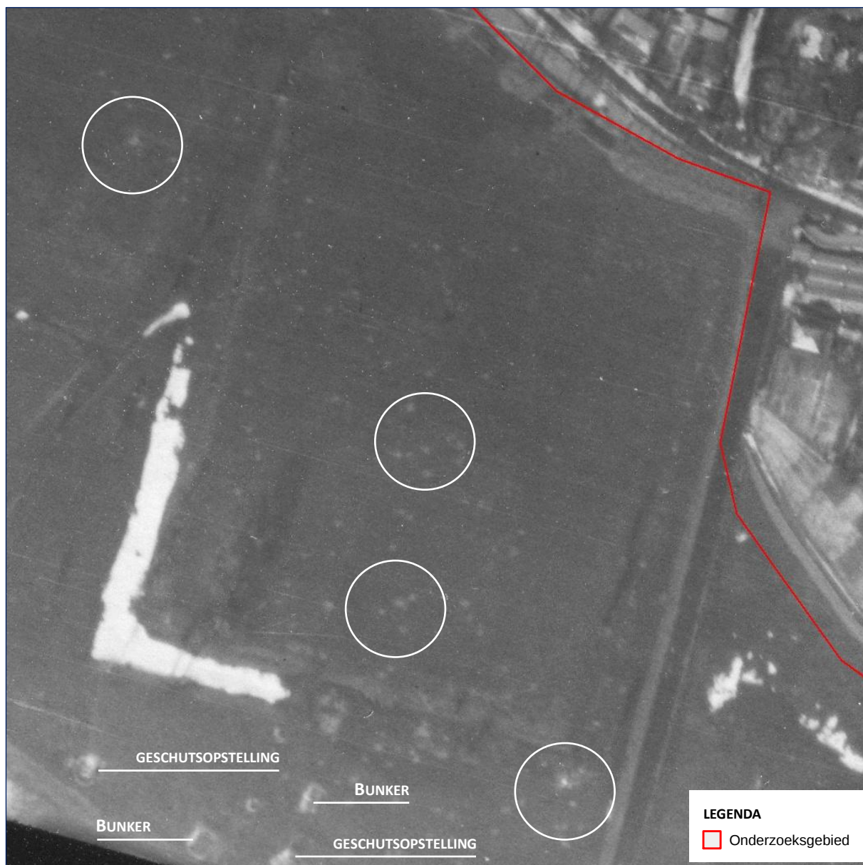
Figuur 22: Detail van een luchtopname van 5 januari 1945 van de uiterwaard ten zuiden van Paardenmarkt. Op deze foto zijn verschillende kraters zichtbaar. Enkele van deze kraters zijn hierboven omcirkeld. De kraters zijn veroorzaakt door inslagen van geschutsmunitie. Nabij de rivier zijn nog steeds de stellingen zichtbaar die op foto's van 23 december 1944 ( figuur 16 ) reeds zijn waargenomen. Daarnaast zijn er enkele vermoedelijke (munitie)bunkers nabij deze opstellingen zichtbaar die op de eerdere foto's nog niet te zien waren.
