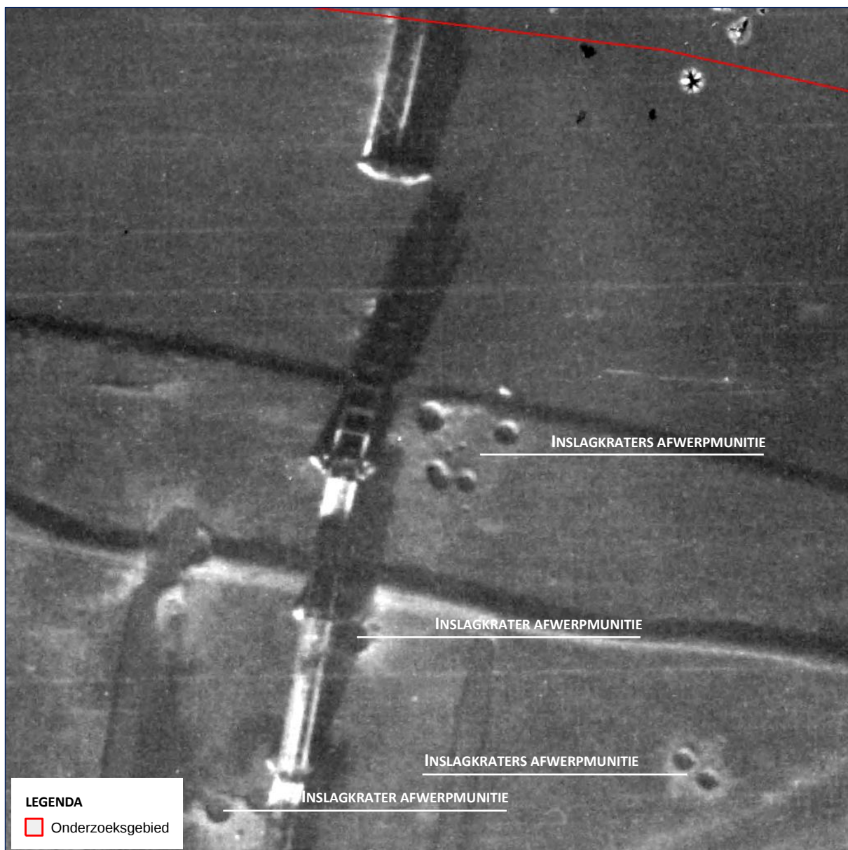
Figuur 20: Detail van de luchtopname uit figuur 17 van de zuidelijke oever nabij de brug over de Nederrijn. Aan weerszijde van de brug zijn (groepen) inslagkraters van afwerpmunitie zichtbaar.
