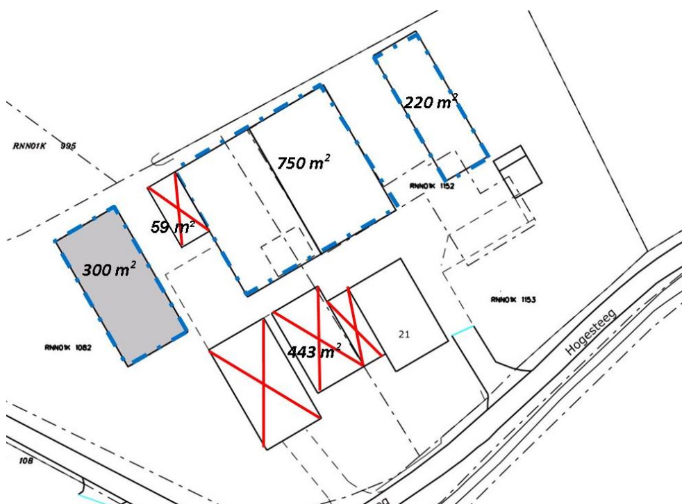
Schematische tekening te slopen en te realiseren schuren
