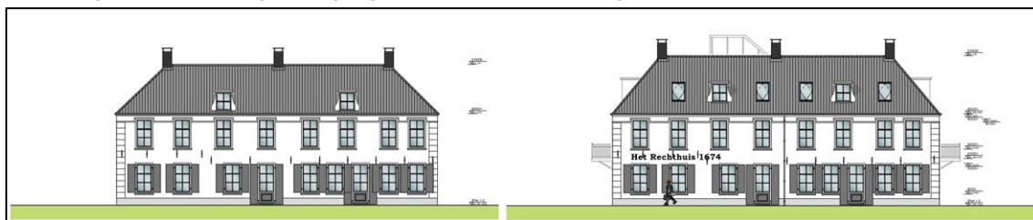
Afbeelding 8: Links de oorspronkelijke gevel en rechts de nieuwe gevel.
