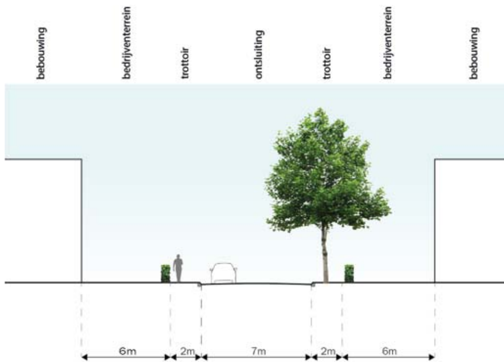
Doorsnede rijbaan - E
