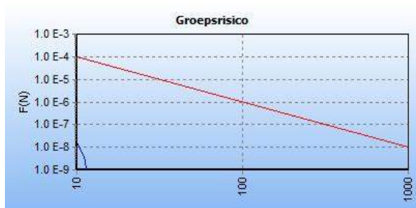
Figuur 6: FN curve van de kilometer met de hoogste overschrijdingsfactor 0.0 van de W-520-05. De ligging van de kilometer met de hoogste overschrijdingsfactor is hiernaast in het rood weergegeven op een topografische kaart.
