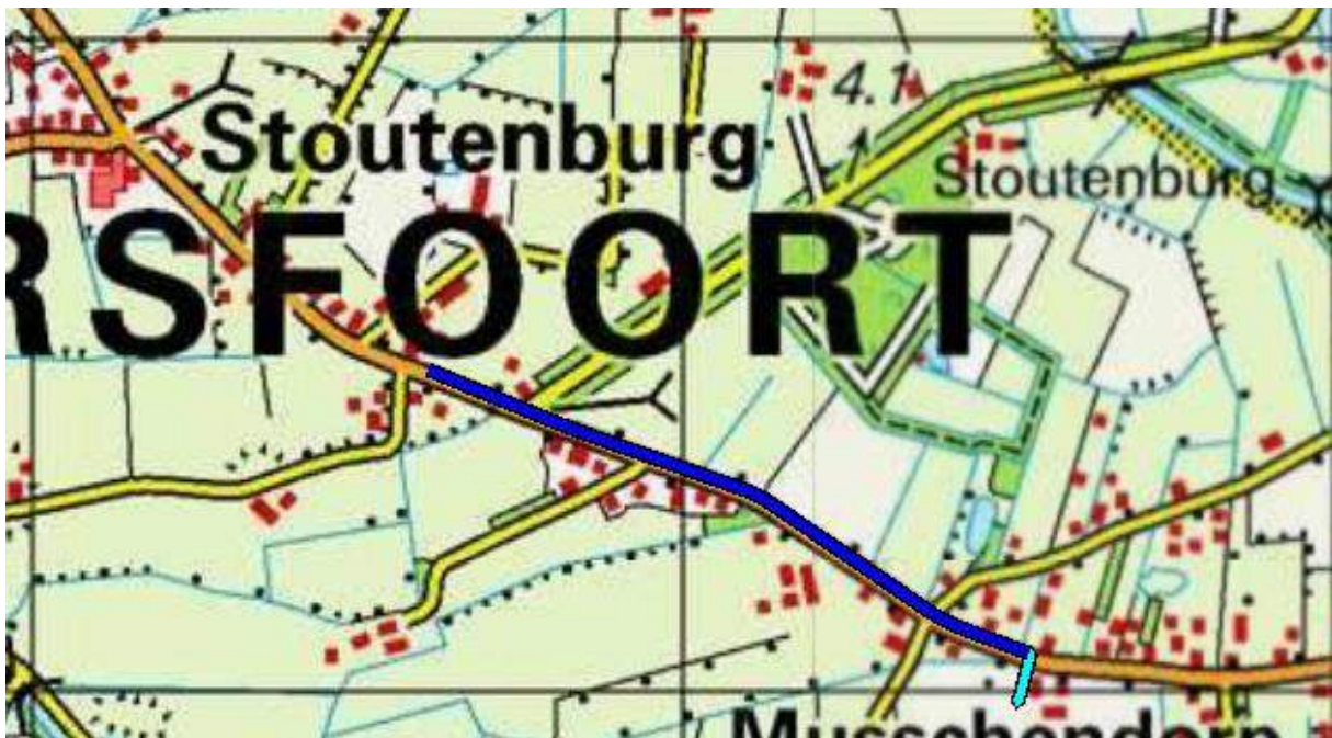
Figuur 1 Ligging van de leiding W-520-05 op een topografische kaart. De ligging van de leiding na de verlegging is weergegeven in lichtblauw; de ligging van de leiding voor de verlegging is weergegeven in donkerblauw.
