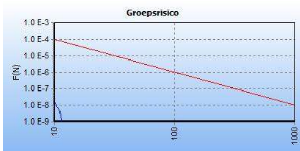
Figuur 4: FN curve van de kilometer met de hoogste overschrijdingsfactor 0.0 van de W-520-05. De ligging van de kilometer met de hoogste overschrijdingsfactor is hiernaast in het rood weergegeven op een topografische kaart.
