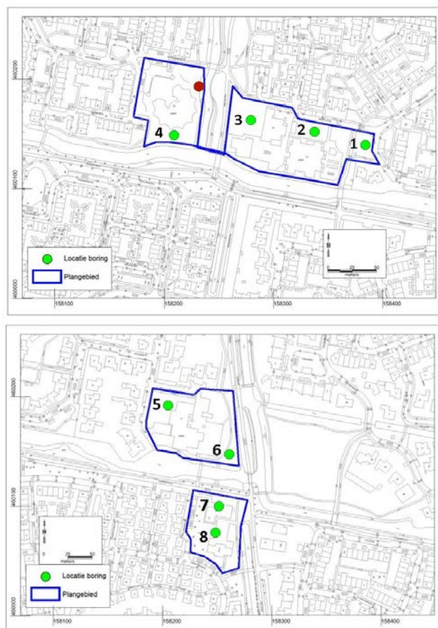
Afbeelding 6a en b, locatie van de boringen (rood is afgevalen vanwege bestrating)
