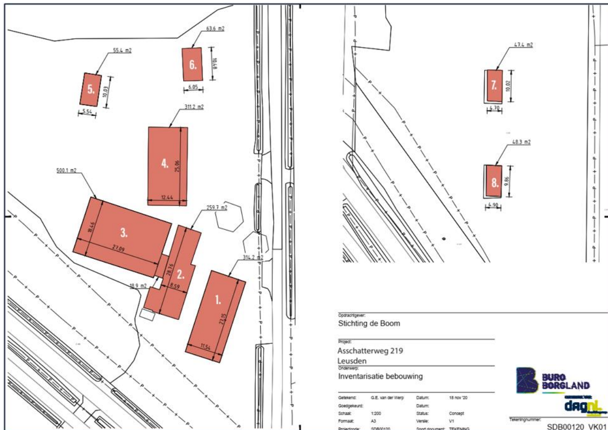
Afbeelding 2.3: Bestaande bebouwing die geheel of ten dele zullen worden gesloopt (bron: Buro Borgland).
