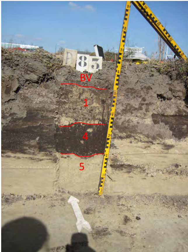
afbeelding 10, profielstaaf 83 ter illustratie van de bodemopbouw in de opgehoogde delen van het onderzoeksgebied (BV=bouwvoor; 1=geel/grijs gevlekt ophogingszand; 4=donkergrijs ploegvoor; 5=lichtgrijs/geel dekzand).
