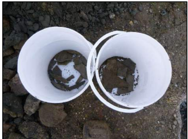
Foto 10: asbestverdacht materiaal proefsleuf SL07
