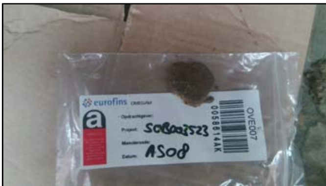
Foto 9: Asbestverdachte materialen proefgat 08
