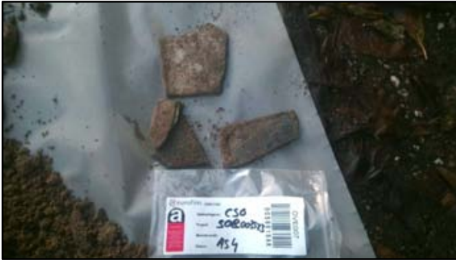
Foto 7: Asbestverdachte materialen proefgat 04
