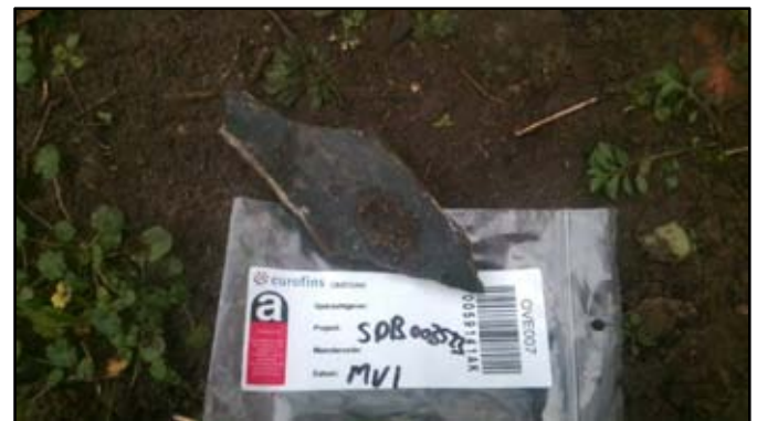
Foto 10: Asbestverdacht materialen op maaiveld
