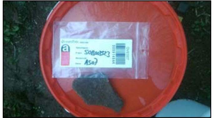
Foto 8: Asbestverdachte materialen proefgat 07
