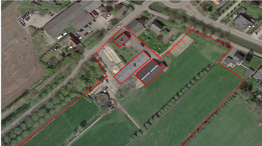
Figuur 2 Overzicht van de bebouwing op de planlocatie aan de Lagedijk 1 met daarin (A) de kapschuur, (B) lage schuur van damwandplaten en (C) de schuur met gemetselde muren, damwandplaat en een golfplaten dak. A t/m C worden gesaneerd ten behoeve van de ontwikkeling van woningen. De woning en de schuur op het perceel (ten noorden) vallen buiten de beoogde ontwikkeling (bron kaartmateriaal: google.com).
