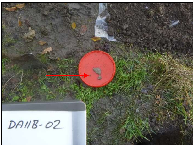
Foto 9: Asbestverdacht materiaal dam DA11-B
